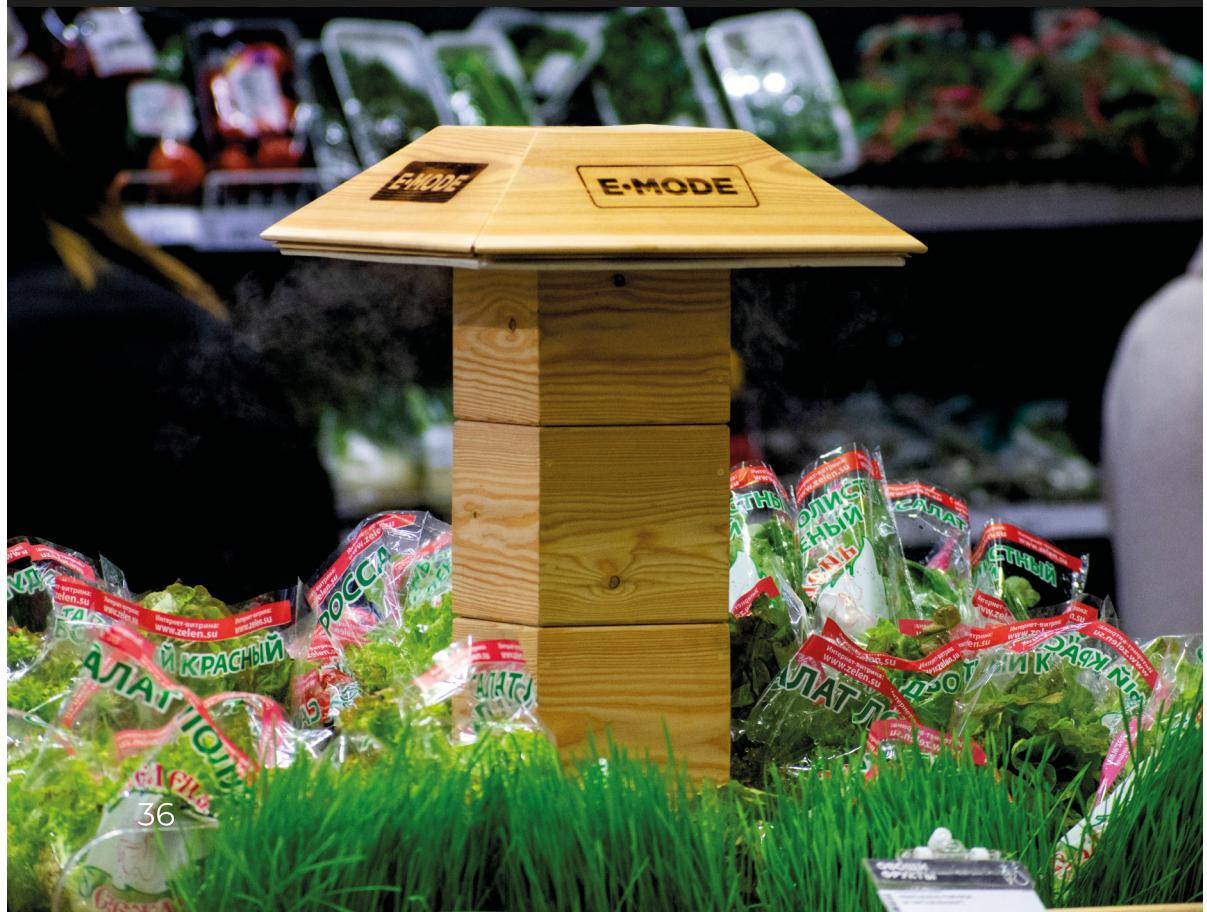
**Система образования тумана** предназначена для поддержания заданного уровня влажности в закрытых помещениях, сохранения полезных свойств свежесрезанной зелени и более эффективного проращивания семян.
